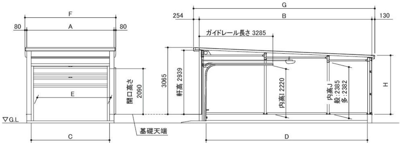
内高I:基礎天端～ドア開放時のドアまで 内高J:基礎天端～後母屋の下端まで
