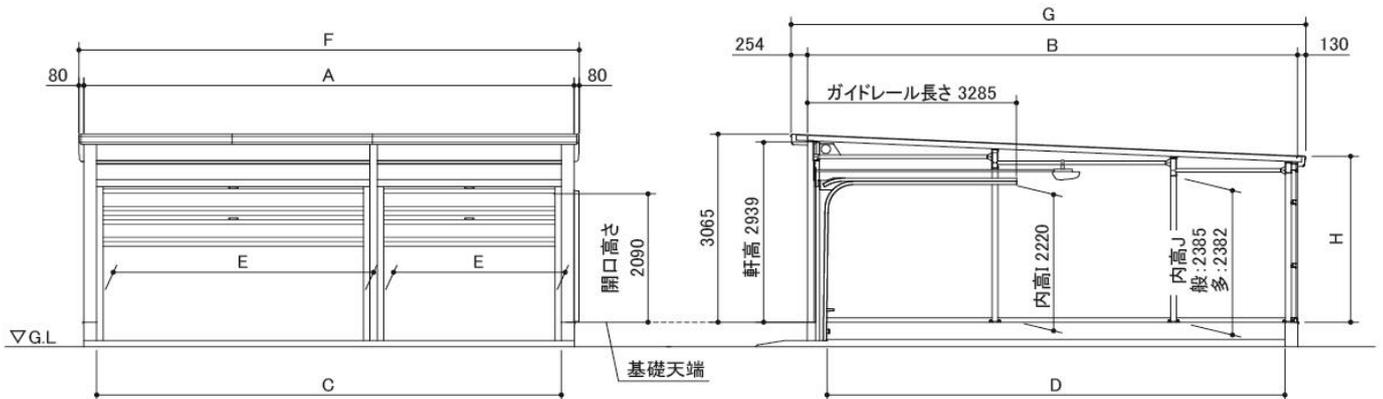
内高I:基礎天端～ドア開放時のドアまで 内高J:基礎天端～後母屋の下端まで
