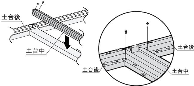
②アンカープレートFWを柱前中にボルト1本(仕切壁を取り付けない場合は2本)で取り付けます。次に、柱前中に取り付けしたアンカープレートFWを土台中に差し込むようにして柱前中を立て、土台中とボルト2本で取り付けます。アンカープレートFWの上部をボルト締めすぎると仕切壁の取付が出来ません。
