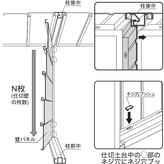
仕切土台中の○部のネジ穴にネジ穴ブッシュを取り付けてください。
