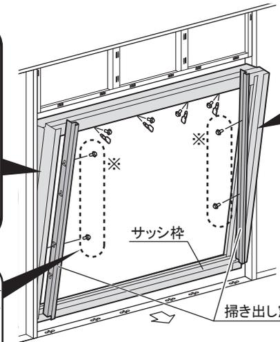
※掃き出し窓の隣が柱の場合、縦方向はネジ板とM6ボルトで取り付けます。
