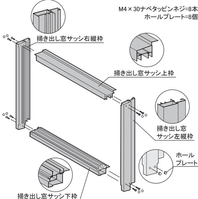
2. 縦補強、掃き出し窓上パネル取付
