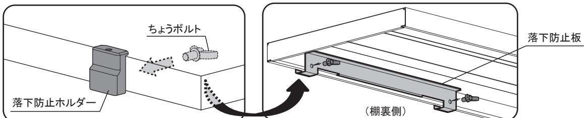
④落下防止バーを落下防止ホルダーの穴へ差し込みます。
