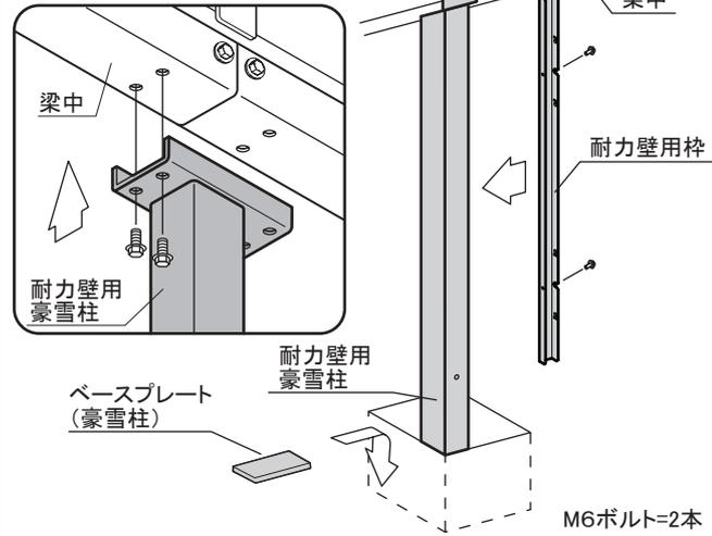
**4** 耐力壁土台を耐力壁用豪雪柱と仕切土台後取付板にM6ボルトで取り付けます。
