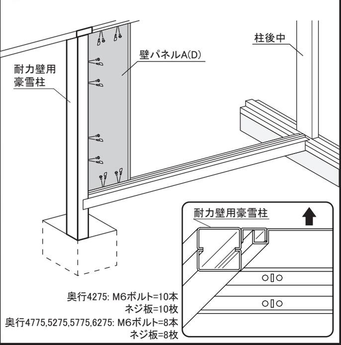
**7** 残りの壁パネルを下図を参考にボルトとネジ板で取り付けます。
