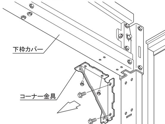
② 柱後中部の土台カバーを止めているM6ボルトをはずし、仕切土台後取付板を取り付けます。
