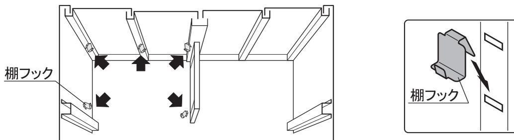
④引出し固定板を後面の棚フックに当て、ボルトで固定します。(2ヶ所)
