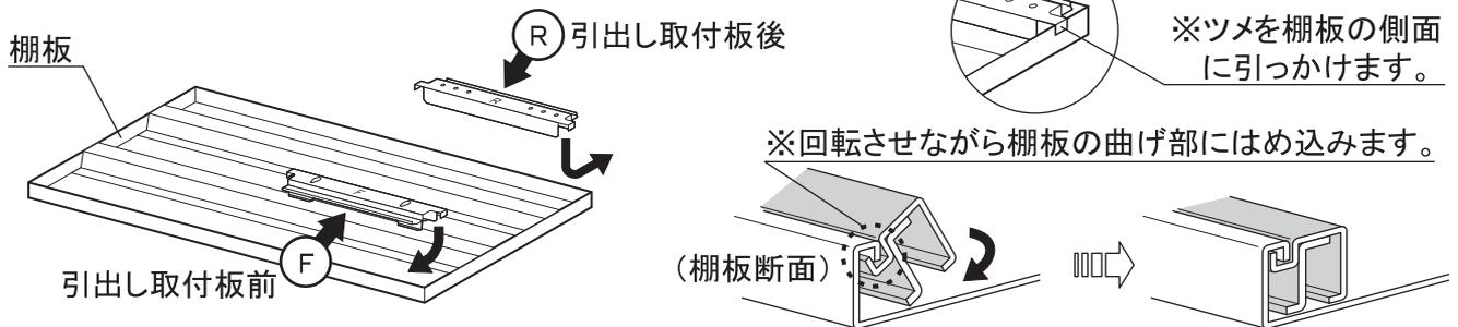
②引出し取付板前のダルマ穴に引出しレール左右の金具を引っ掛け、引出し取付板後にボルトで固定します。
