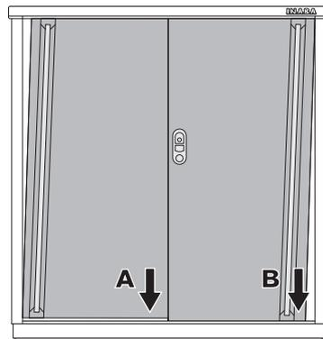
※3mm以上のスキマや上記の要領で調整できない時は、目隠しキャップをはずしベースの水平を出し直してください。(「2.ベース設置」を参照)
