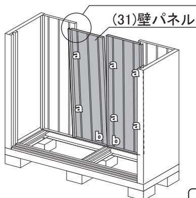
※先に取り付けてある壁パネルに、コの字の曲げ部をかぶせて取り付けます。
