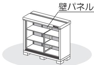
①壁パネルを側板後ろにはめ込み、縦方向(a)をボルトとパッキン付ネジ板で取り付け、横方向(b)をボルトとネジ板で取り付けます。
