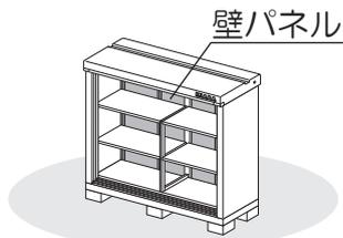
①壁パネル(大)を側板後ろにはめ込み、縦方向(a)をボルトとパッキン付ネジ板で取り付け、横方向(b)をボルトとネジ板で取り付けます。
