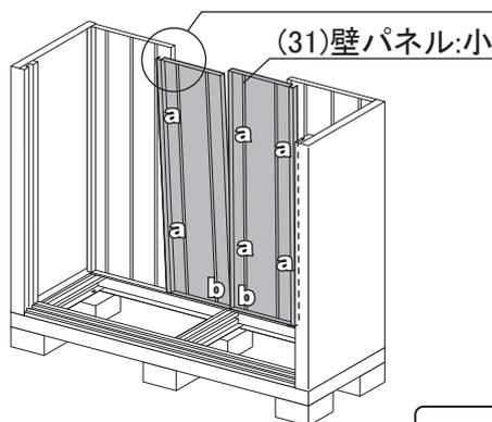
※先に取り付けてある壁パネルに、コの字の曲げ部をかぶせて取付けます。
