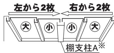
※ 棚支柱Aは「6.棚支柱A取付」で取付けます。
