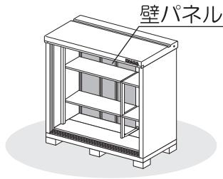
①壁パネル(大)を側板後ろにはめ込み、縦方向(a)をボルトとパッキン付ネジ板で取り付け、横方向(b)をボルトとネジ板で取り付けます。
