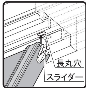
スライダーの先をアルミレールに空いている長丸穴に差し込み扉を取り付けてください。
