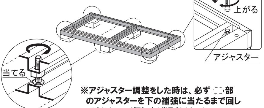
※アジャスター調整をした時は、必ず<sup>△</sup>部のアジャスターを下の補強に当たるまで回してください。(但し上げ過ぎると、シーソーのようになりますので注意してください。)
