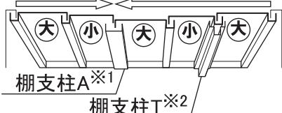
\*先に取り付けてある壁パネルに、コの字の曲げ部をかぶせて取り付けます。
