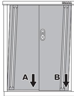
※3mm以上のスキマや上記の要領で調整できない時は、目隠しキャップをはずしベースの水平を出し直してください。(「2.ベース設置」を参照)
