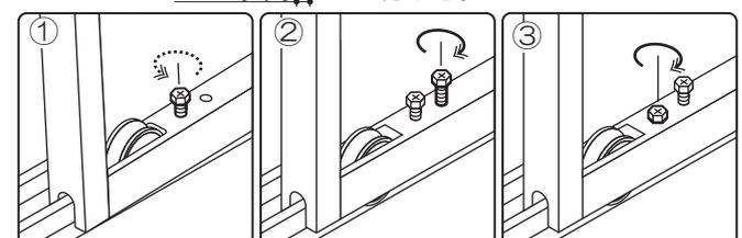
※3mm以上のスキマや上記の要領で調整できない時は、目隠しキャップをはずしベースの水平を出し直してください。(「2. ベース設置」を参照)
