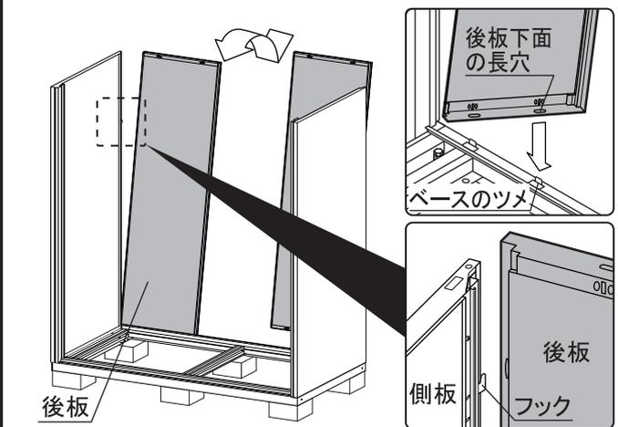
後板とベースをボルトとネジ板で仮締めします。
