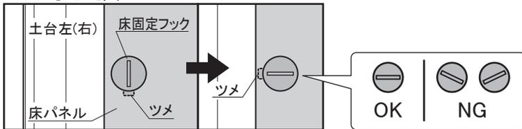
床固定フックのツメが外側に向くように90度回転させます。
