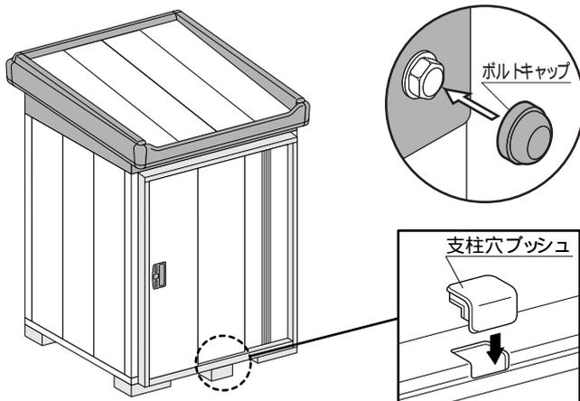
支柱穴プッシュはサイド扉の開口部の角穴と棚支柱Aをはずして、ガラス窓を取り付けた時の角穴に取り付けてください。
