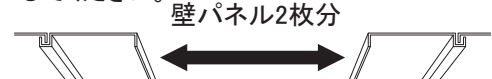
図A: 壁パネルのフラットな面が内側に来るようにしてください。
