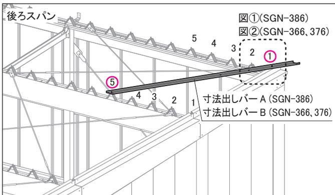
※ブレースを締め付けた後、プレート B をとめている M8 ボルト、ブレースを取り付けている M16 と M12 ボルトを忘れずに本締めしてください。
