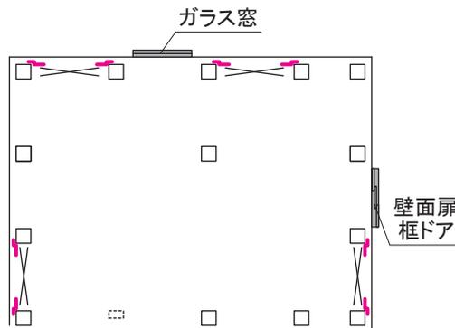
壁面扉・框ドア、ガラス窓を避けてブレースを張るようにプレート B を取り付けます。
