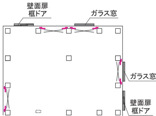
同じ面に壁面扉・框ドア、ガラス窓がつく場合はガラス窓側にブレースを張れるようにプレート B を取り付けます。
