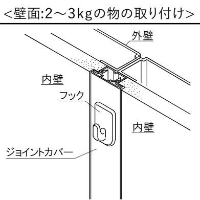
内壁と内壁の継ぎ目のジョイントカバーを利用してください。
