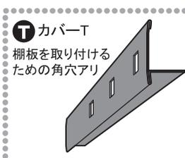
※ 別売棚は、P13の【20.別売棚取付図】を参考にカバー-Bをカバー-Tに差し替えて取り付けて下さい。
