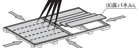
※床パネルにスキマができる場合は、ボルトを緩めて矢印方向に土台枠を寄せて調整し再度ボルトを締め直してください。
