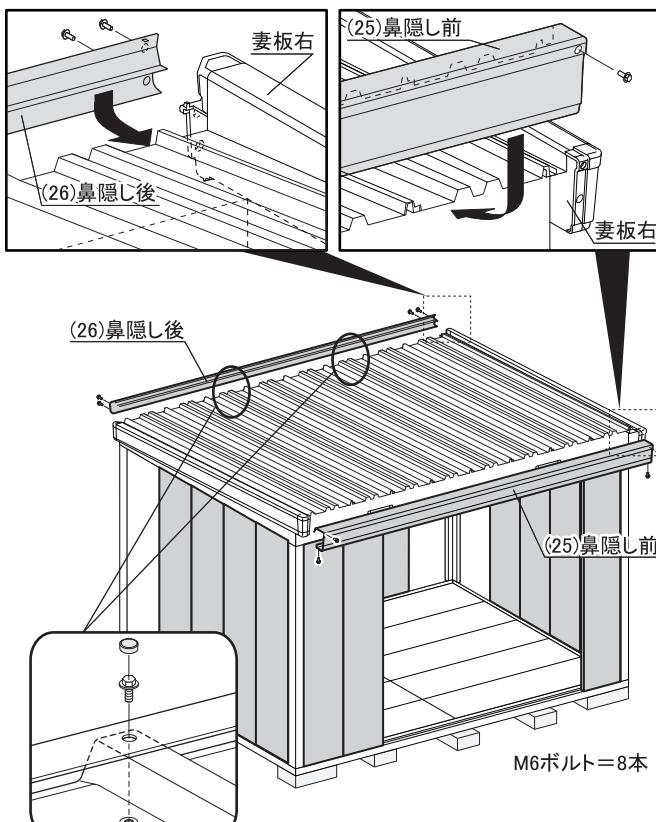
屋根後部と鼻隠し後をボルト(L=18mm)
