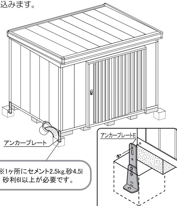
B) 地盤がコンクリートの場合は、アンカープレートを取り付け、M10オールアンカー(市販品)で固定します。
