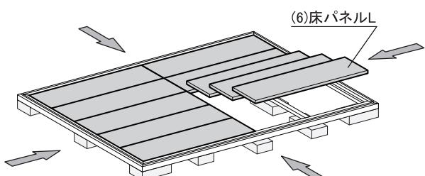
※ 床パネルにスキマができる場合は、ボルトを緩めて矢印方向に土台枠を寄せて調整し再度、ボルトを締め直してください。
