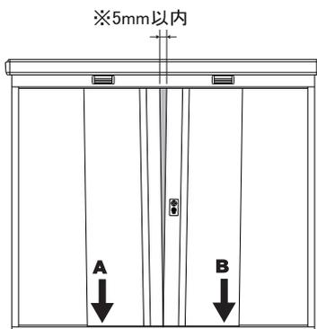
①戸車を固定しているボルトを4~5回転ゆるめる。
