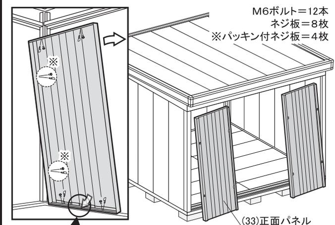
正面パネルの下部は、庫内側へ押し込む様に取り付けてください。
