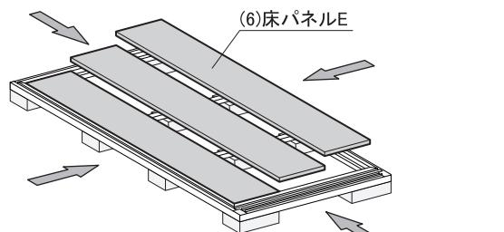
※ 床パネルにスキマができる場合は、ボルトを緩めて矢印方向に土台枠を寄せて調整し再度、ボルトを締め直してください。
