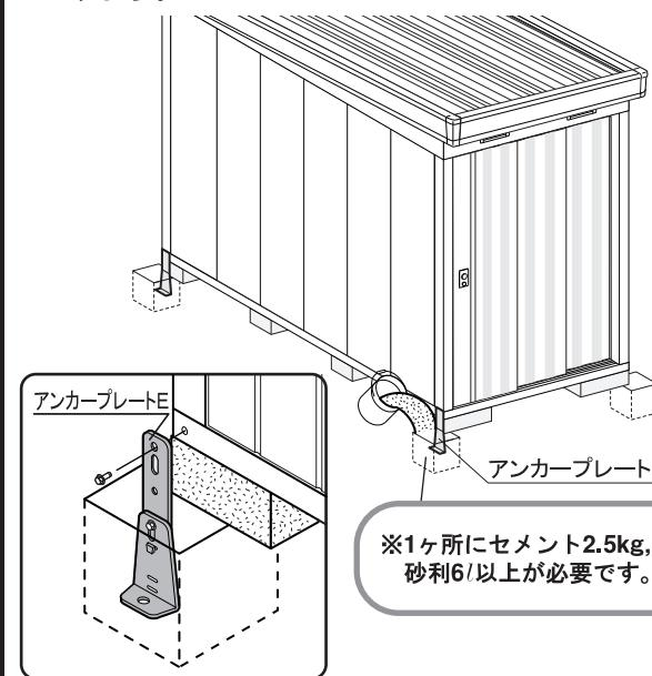
B) 地盤がコンクリートの場合は、アンカープレートを取り付け、M10オールアンカー(市販品)で固定します。
