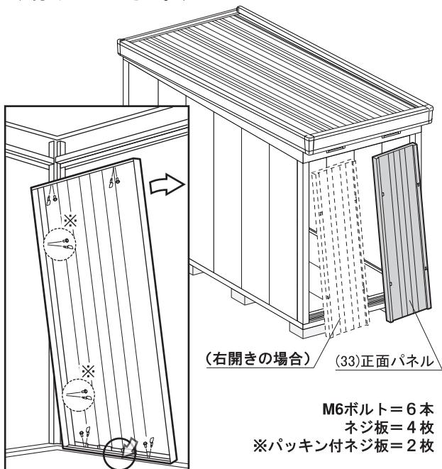
正面パネルの下部は、庫内側へ押し込む様に取り付けてください。
