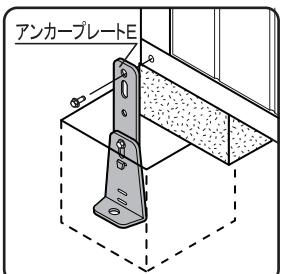
B) 地盤がコンクリートの場合は、アンカープレートを取り付け、M10オールアンカー(市販品)で固定します。
