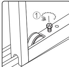
②部品箱内の戸車調整用のボルトで戸当たりを調整する。
