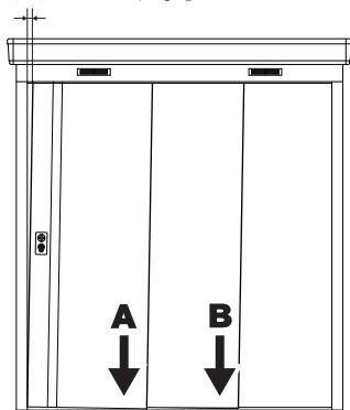
①戸車を固定しているボルトを4~5回転ゆるめる。
