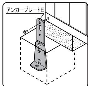
B) 地盤がコンクリートの場合は、アンカープレートを取り付け、M10オールアンカー(市販品)で固定します。
