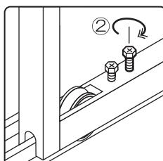
③最初にゆるめたボルトを締め付ける。
