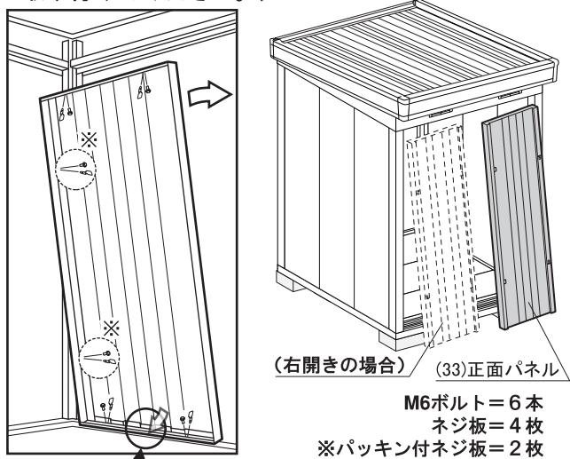
正面パネルの下部は、庫内側へ押し込む様に取り付けてください。
