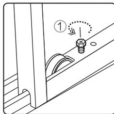
②部品箱内の戸車調整用のボルトで戸当たりを調整する。
