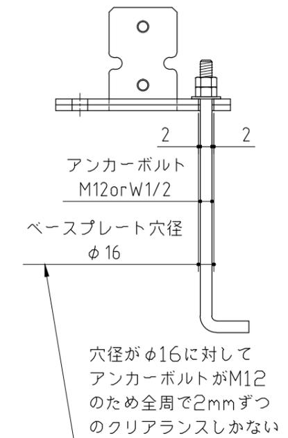
穴径がφ16に対してアンカーボルトがM12のため全周で2mmずつのクリアランスしかない
