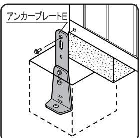
B) 地盤がコンクリートの場合、アンカープレートを取り付け、M10オールアンカー(市販品)で固定します。
