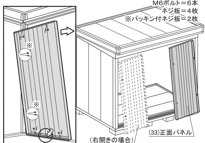
正面パネルの下部は、庫内側へ押し込む様に取り付けてください。
